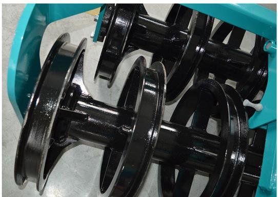
Шахматное расположение колец **тяжелого тандемного катка с U-образным профилем** хорошо влияет на самоочищение. Основательно прикатывает. Стабилизирует работу агрегата по глубине на счет эффекта самоочищения.
