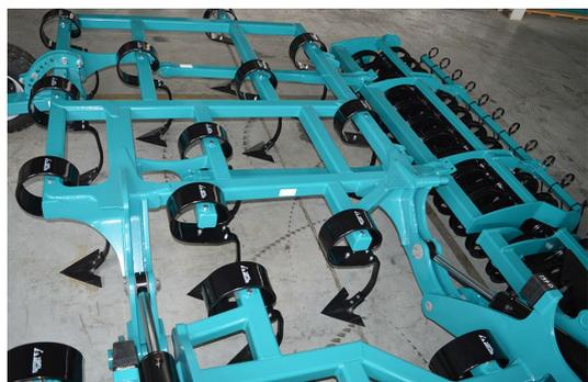
**Конструкция рамы** мощная и жесткая. Выполнена из трубы 100x100x10 мм. Боковые рамы копируют контур почвы.
