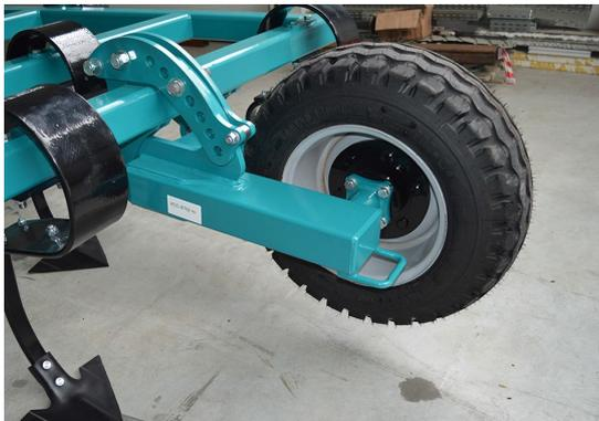
Культиватор комплектуется передними **опорными колесами**. Регулировка колес происходит с помощью пальцев.
