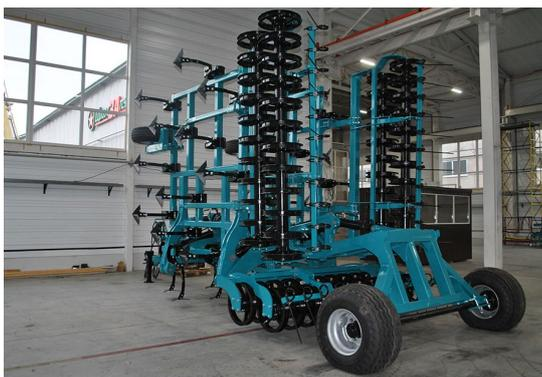
Широкая, усиленная **ходовая тележка** обеспечивает безопасные перегоны. Расширенная колея для боковой устойчивости. Транспортные габариты ширина 3 м высота 4 м.
