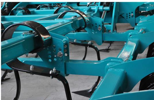
Простая и быстрая **настройка глубины обработки** за счет пальцев на опорном прикатывающем катке.
