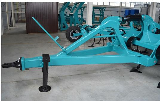
**Усиленная треугольная сница** со сменной серьгой обеспечивает высокую маневренность агрегата при поворотах. Возможна комплектация поперечной планкой для трехточечной навески трактора категории 3 и 4.
