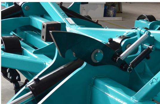
**Автоматическое стопорение** рамы управляется гидравликой, нет необходимости выхода водителя из кабины.
