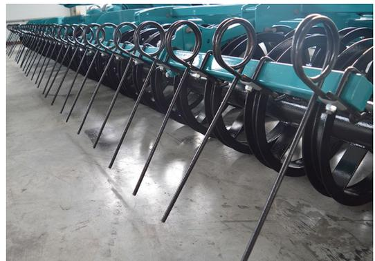
**Расширенные регулировки скребниц:** угол наклона, угол атаки и общее положение бороны относительно почвы. Скребницы служат для оптимального распределения соломы, выравнивания и крошения структуры почвы.
