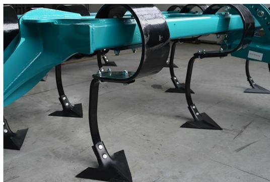
**Вибро-стойки** долговечны и устойчивы к ударам и камням. Не требуют технического обслуживания, благодаря своей постоянной вибрации лучше разрушаются комья почвы.
